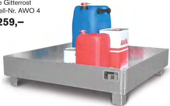
Auffangwannen zur Lagerung von 1 bis 4 Fässern (200 Liter) oder einer entsprechenden Anzahl von Kleingebinden ▪ 3 mm Stahlblech ▪ Oberfläche feuerverzinkt nach EN ISO 1461 ▪ mit Stützfüßen, Unterfahrhöhe 100 mm ▪ transportabel mit Gabelhubwagen und Gabelstapler
