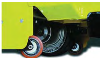
Fünf-Punkt-Auflage für kurvensicheres Handling
